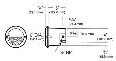
La lente de la luminaria deberá ser de vidrio prismático temperado sellada al marco con silicón. El marco de la luminaria deberá contar con tratamiento con polvos (TGIC), aplicados electrostáticamente, secados en horno, para garantizar la resistencia a la pérdida de color y la abrasión. El voltaje deberá ser universal de 120 a 227V con una tolerancia del 10%.
